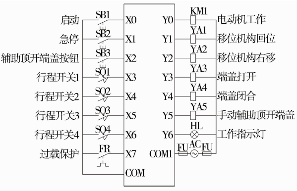
图 3 快开装置 PLC 接线图
