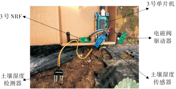
图 10 土壤湿度测控模块实物图
