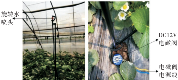
图 11 水喷头和电磁阀实物图
